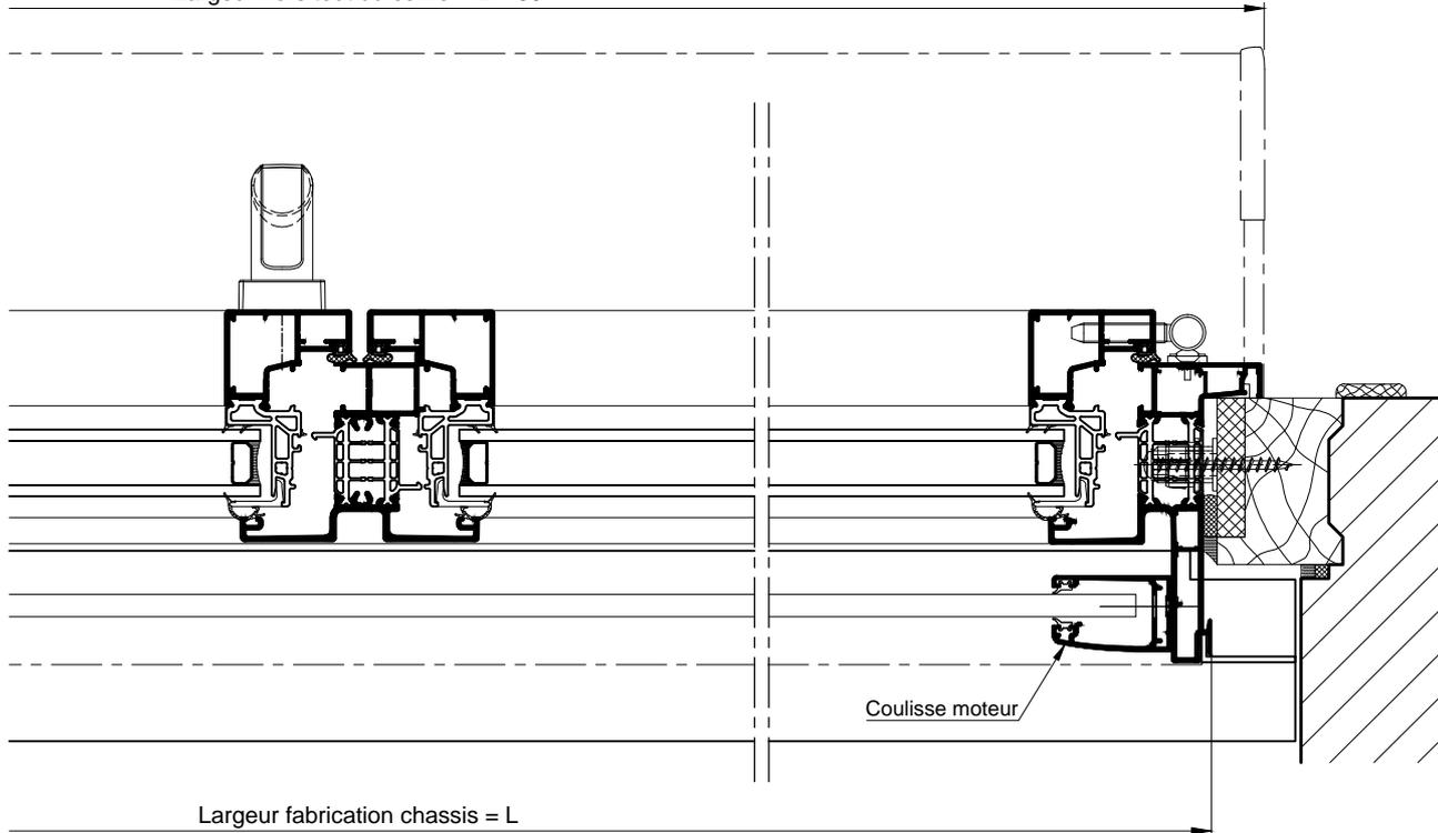
**AVEC COUVRE-JOINT INTERIEUR DE 20 MM ( CAS COMMANDE MANUELLE OU DE SECOURS )**
