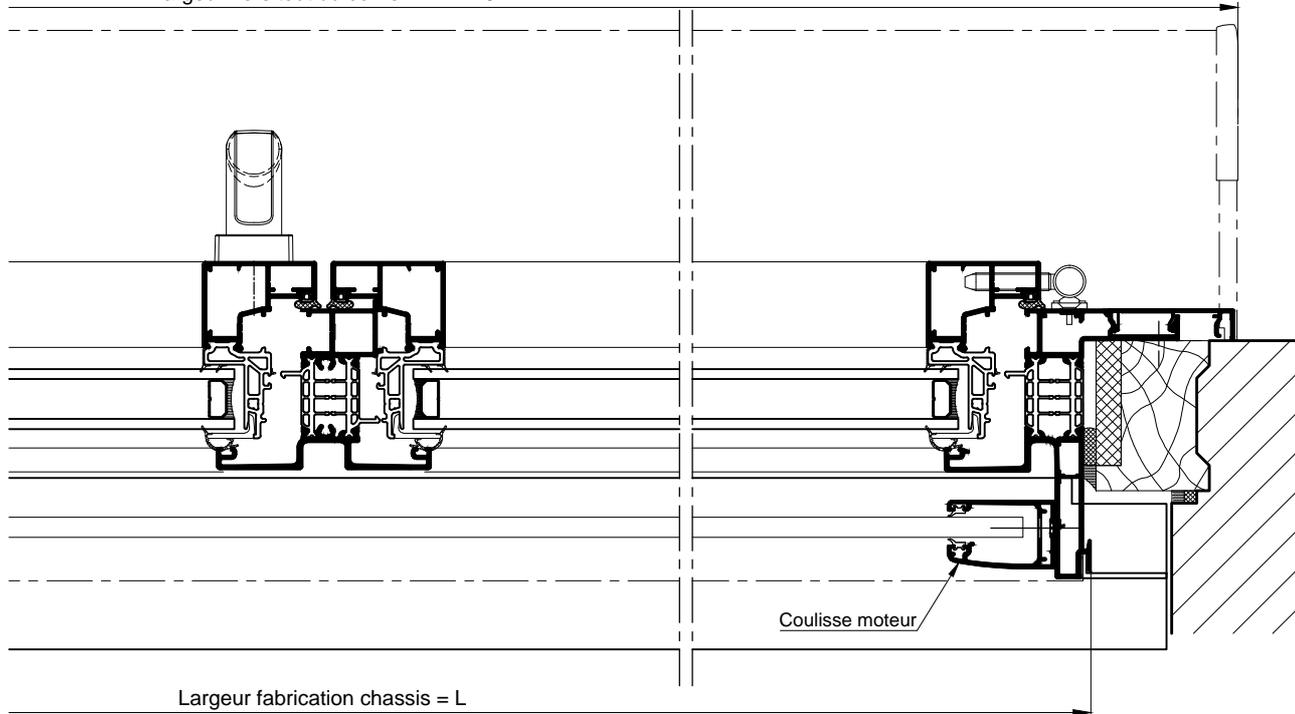
**AVEC COUVRE-JOINT INTERIEUR DE 60 MM ( CAS COMMANDE MANUELLE OU DE SECOURS )**
