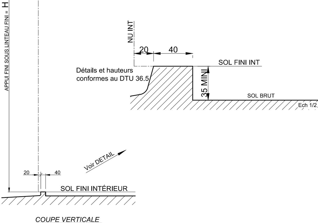
**Attention : les frappes K.LINE doivent obligatoirement être posées sur des maçonneries finies.**
