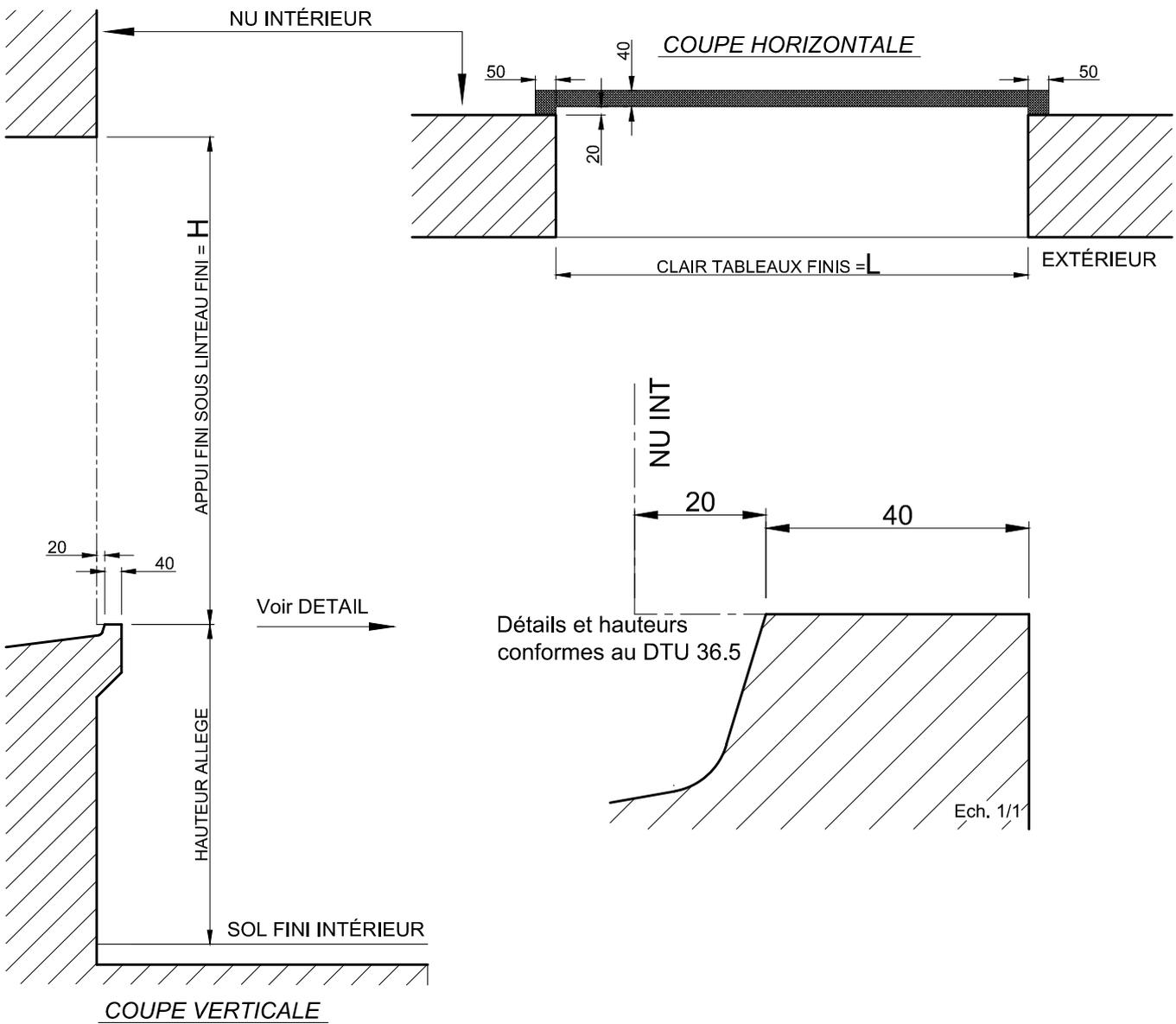
Attention : Les frappes K.LINE doivent obligatoirement être posées sur des maçonneries finies.
