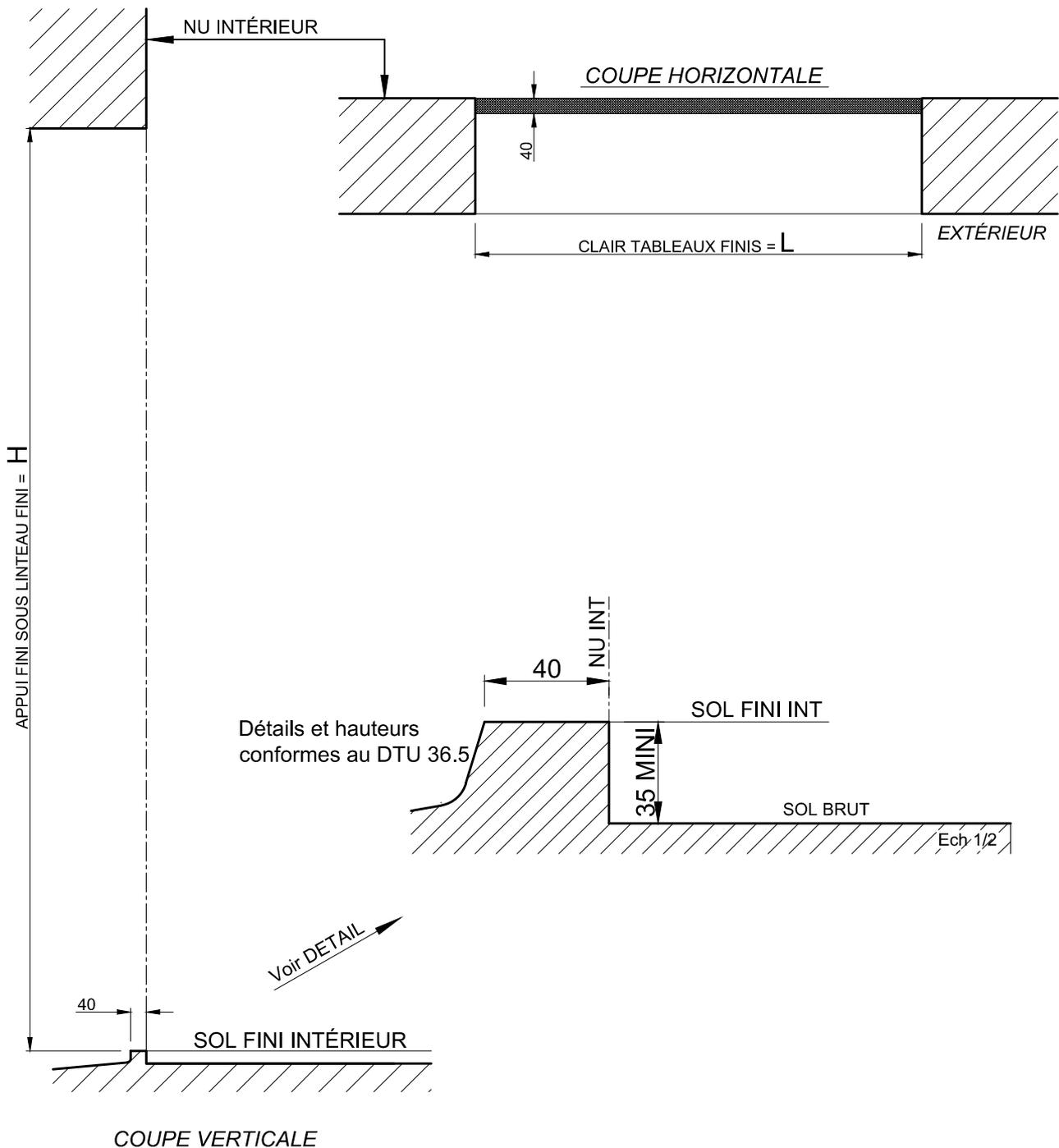
Attention : les frappes K.LINE doivent obligatoirement être posées sur des maçonneries finies.
