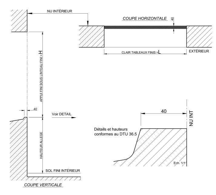
Attention : Les frappes K.LINE doivent obligatoirement être posées sur des maçonneries finies.
