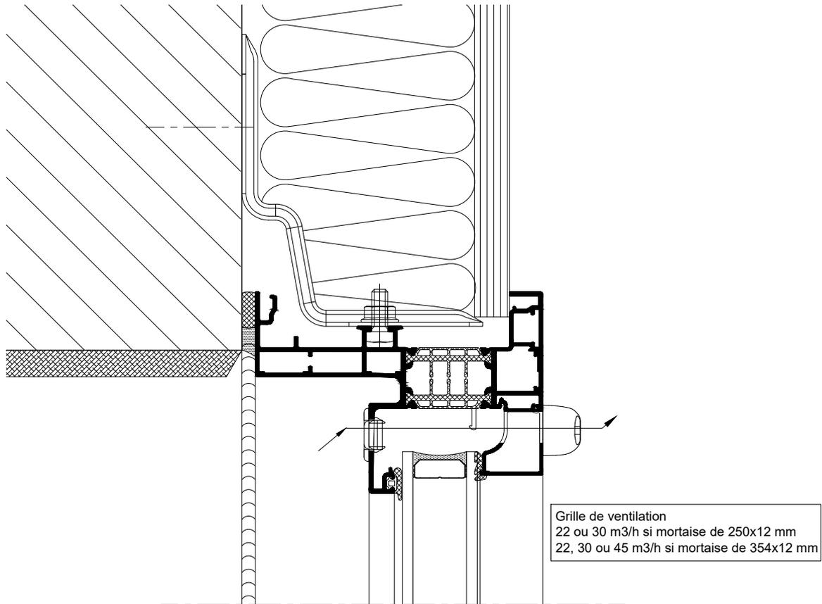
Réalisable en fixe parclosage intérieur avec remplissage d'épaisseurs 24 ou 30mm
