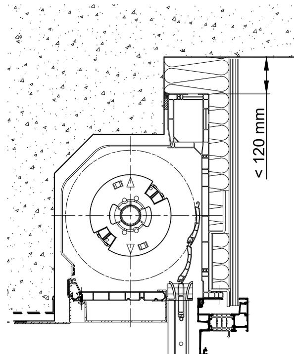
Si hauteur entre coffre et dalle  $\geq$  120mm, le renforcement
