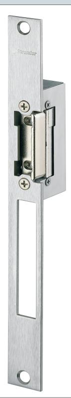
**La gâche électrique** est un élément de serrure permettant de déverrouiller la porte à distance. Son activation entraîne le relâchement de la gâche et la libération du pêne sans avoir à actionner le cylindre.
