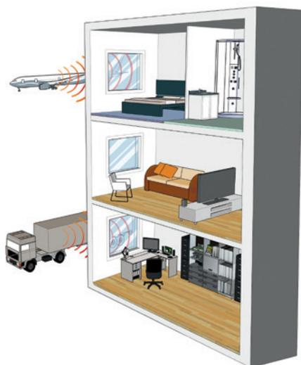
L'essai consiste à mesurer la différence de bruit entre l'extérieur et le bruit à l'intérieur de la pièce. Toutes les voies de transmission sont prises en compte (transmissions directes, latérales, parasites,...)\*.
